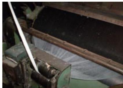
Y este velo es el que, al juntarse, produce una larga “mecha” que va colocándose, en forma de espiral, en depósitos cilíndricos. Estos depósitos son llevados, entonces, a una cuarta máquina llamada “veloz” que se encarga de transformar el algodón de “mecha” en “pabilo”; es decir, el usado para producir un primer hilo grueso y resistente que se enreda en “carretes”.
